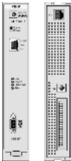
Шлюз **PRIM** содержит **1** порт первичного интерфейса ISDN PRI (30B+D). Интерфейс поддерживает **30** речевых каналов. Шлюз **PRIM** выполнен на основе цифрового сигнального процессора (DSP), который обеспечивает кодирование информации в соответствии со стандартами G.711, G.729a/b, G.723.1.
